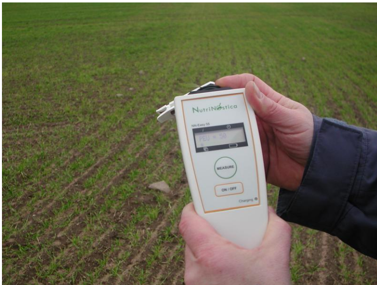
Mätning i fält med mangantestaren NN-Easy55
